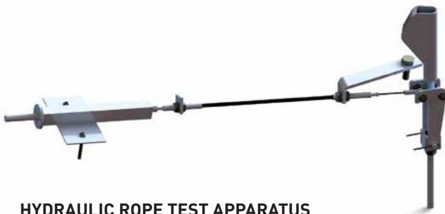
**HYDRAULIC ROPE TEST APPARATUS**
