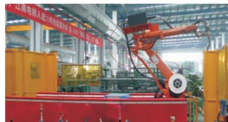
Роботизированные сварочные станции
